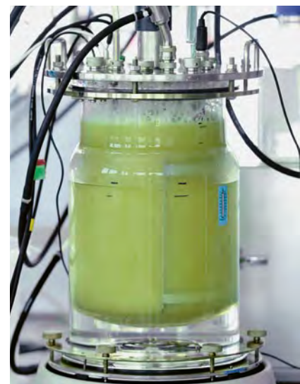
Ein spezieller Stamm von Archaeen wandelt Wasserstoff und Kohlendioxid in Methan, das sich direkt in das Erdgasnetz ein- speisen lässt.
